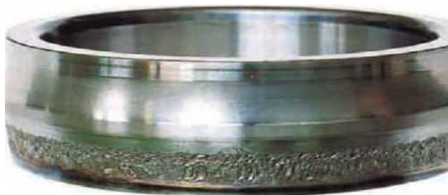
Рисунок 1.8 – Внутреннее кольцо подшипника качения с усталостным выкрашиванием только одного следа вращения по всей периферии
